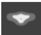
[T2] Тип II, Асимметричный, Боковой - 130x85°
