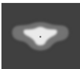
[T2] Typ II, Asymmetrisch, Seitenwurf - 137x52°
