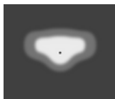
[T3] Typ III, Asymmetrisch, Seitenwurf - 143x68°
