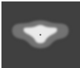
[T2] Тип II, Асимметричный, Боковой - 130x85°
