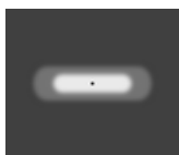
[T1] Typ I, Asymmetrisch, Seitenwurf - 111x48°
