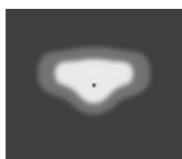
[T3] Typ III, Asymmetrisch, Seitenwurf - 143x63°
