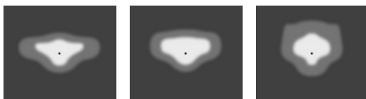
[T2-2] Typ II, Asymmetrisch, Seitenwurf - 149x54° [T3] Typ III, Asymmetrisch, Seitenwurf - 143x63° [T4] Typ IV, Asymmetrisch, Vorwärtswurf - 117x64°
