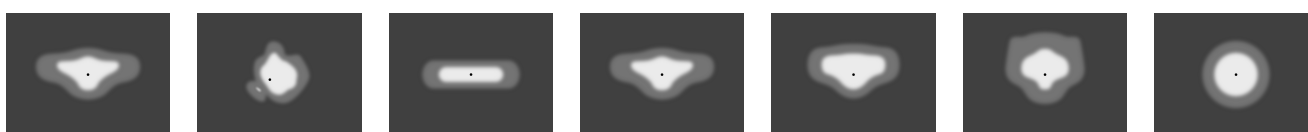
[T2] Тип II, Асимметричный, Боковой [P4] Специальное распределение пешеходных переходов - движение по правой стороне [T1] Тип I, Асимметричный, Боковой [T2-2] Тип II, Асимметричный, Боковой [T3] Тип III, Асимметричный, Боковой [T4] Тип IV, Асимметричный, Передний [T5] Тип V, Симметричный
