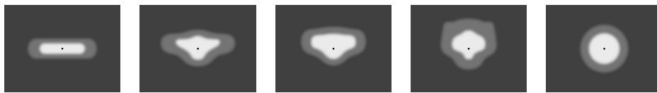
[T1] Тип I, Асимметричный, Боковой [T2] Тип II, Асимметричный, Боковой [T3] Тип III, Асимметричный, Боковой [T4] Тип IV, Асимметричный, Передний [T5] Тип V, Симметричный
