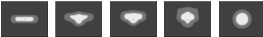
[T1] Typ I, Asymmetrisch, Seitenwurf [T2] Typ II, Asymmetrisch, Seitenwurf [T3] Typ III, Asymmetrisch, Seitenwurf [T4] Typ IV, Asymmetrisch, Vorwärtswurf [T5] Typ V, Symmetrisch
